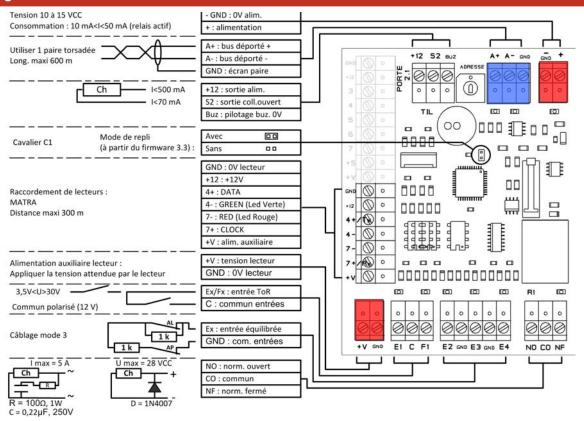
**Protection des équipements :** Afin d'assurer un parfait fonctionnement des équipements et éviter les interférences, raccorder le 0 volt des cartes électroniques à la terre.
